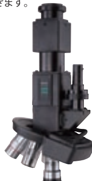
写真：WIDE VMU への装着例 (レボルバ・対物レンズはオプションです)
