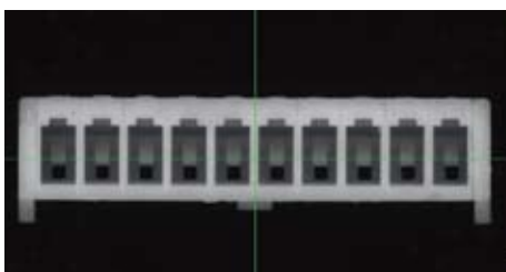
大口径 4 分割 LED 照明によるプラスチック成形品表面画像
