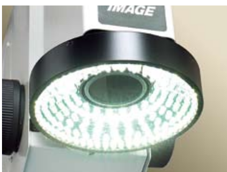
大口径 4 分割 LED リング照明（全点灯時）
